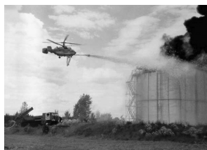
Рис. 2. Использование пеногасящих составов в комбинации с вододисперсными пушками.
