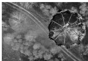
Рис. 1. Мягкая цилиндрическая емкость с большим жестким кольцом для забора воды.
