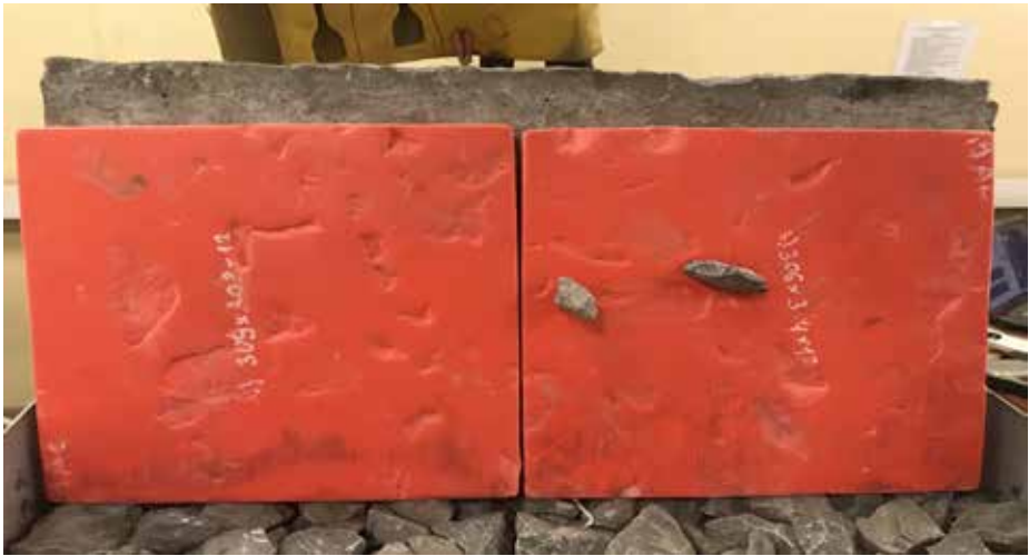
Рис. 5. Внешний вид ПШП среднего типа после испытаний [выполнено авторами].
