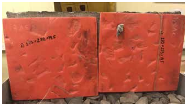
Рис. 4. Внешний вид ПШП мягкого типа после испытаний [выполнено авторами].
