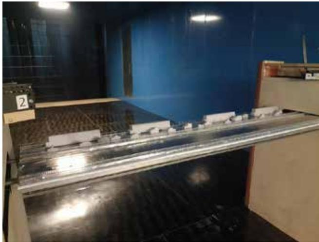
Рис. 12. Модель пролетного строения моста (автомобильный трафик) [выполнено О. И. Поддаевой, П. С. Чуриным, А. Н. Федосовой].
