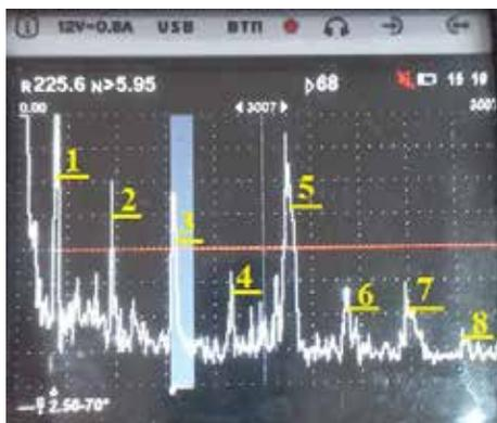
Рис. 6. Дефектограмма выявления отражателей в НО ПЭП П121–2,5–70-РДМ:
