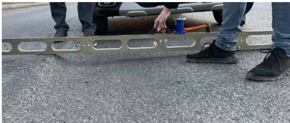
Рис. 1. Гребень выпора на асфальтобетонном покрытии с поверхностной пластической колеей [фотоматериал авторов].
