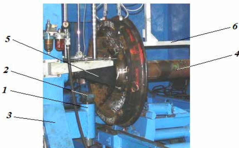
Рис. 4. Фрагмент устройства для перемещения колесных пар в составе установки 3 для измерения геометрических параметров: 1 – механизм вертикального перемещения колесной пары в позицию измерения (гидроцилиндр), 2 – опора с накладками, 3 – стенд установки для измерения геометрических параметров, 4 – колесная пара в позиции измерения, 5 – блок измерения диаметров шейки оси, 6 – блок измерения диаметров оси колесной пары [14].
