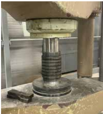
Рис. 1. Обойма для изготовления образцов [фото авторов].
