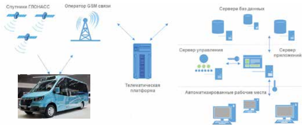
Рис. 8. Автоматизированная система управления транспортной мобильностью в горной местности Республики Дагестан [автор Филиппова Н. А.].
