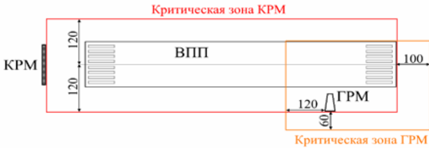
Рис. 1. Критические зоны КРМ и ГРМ (размеры приведены в метрах) согласно требованиям ФАП-297.
