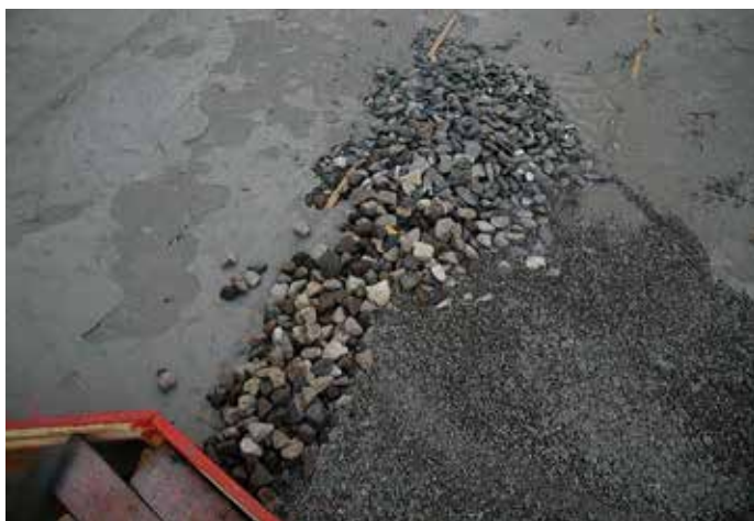
Рис. 6. Вид каменнонабросной буны по окончании эксперимента [фото автора].
