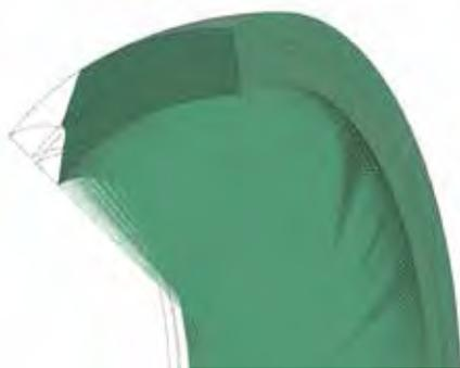
Рис. 6. Форма шарнира с равноупругостью резиновых слоёв по результатам моделирования [получены авторами].
