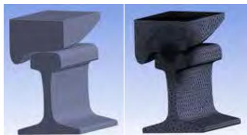
Рис. 5. Объёмная конечно-элементная модель контакта колеса и рельса [выполнено авторами].
