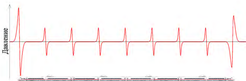
Рис. 1. Принципиальный график изменения величины воздушного давления вдоль высокоскоростного поезда [разработано автором].
