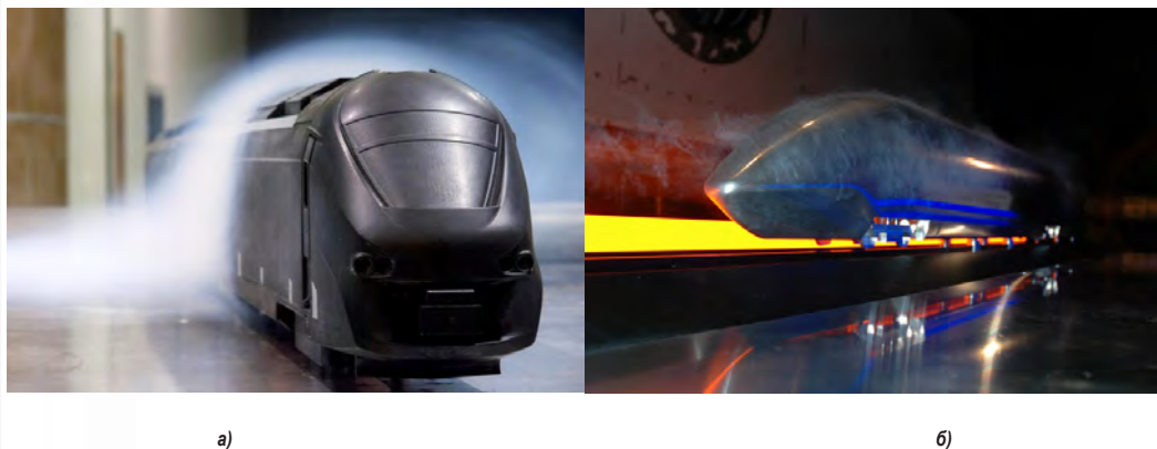
Рис. 2. Испытания моделей поездов в аэродинамических трубах: а – электропоезд на платформе Siemens Velaro, б – электропоезд на платформе Alstom AGV [ https://www.dlr.de/next/desktopdefault.aspx/tabid-6710/11006_read-25184/ , https://www.techinsider.ru/technologies/10632-protiv-vetra-aerodinamika/ ].
