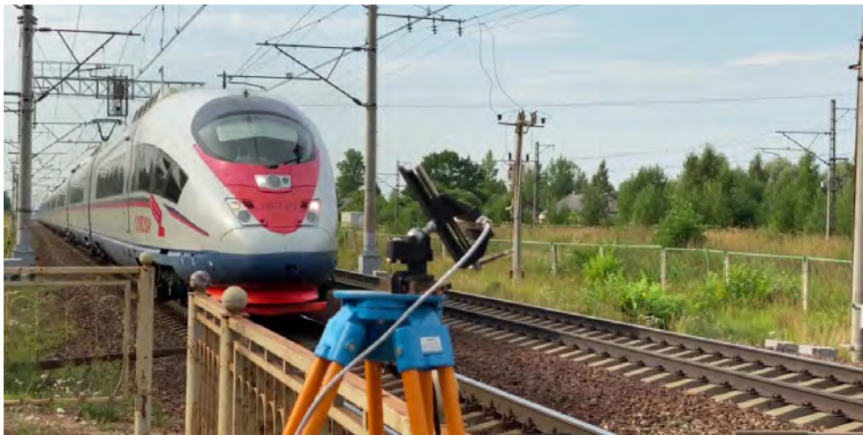
Рис. 10. Процесс измерения аэродинамического воздействия от высокоскоростного электропоезда «Сапсан» [выполнено автором].
