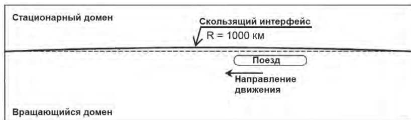
Рис. 7. Принципиальная схема модели на основе модели «ротор–статор» [разработана автором].
