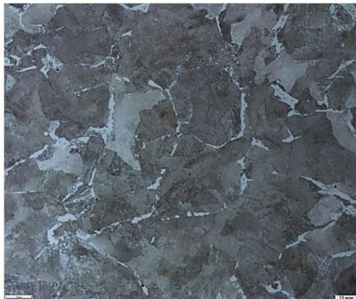
Рис. 1. Микроструктура основного металла колёсной стали 2,  $\times 1000$  [выполнено авторами].
