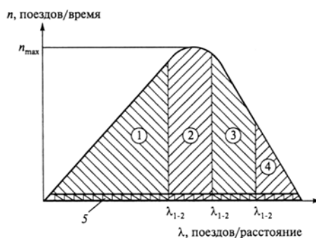
Рис. 4. Режимы поездной работы: 1 – нормальный, 2 – оптимальный, 3 – утяжелённый, 4 – тяжёлый, 5 – аварийный [выполнено автором].
