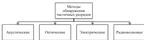
Рис. 2. Методы контроля частичных разрядов и их обнаружения [составлено автором].
