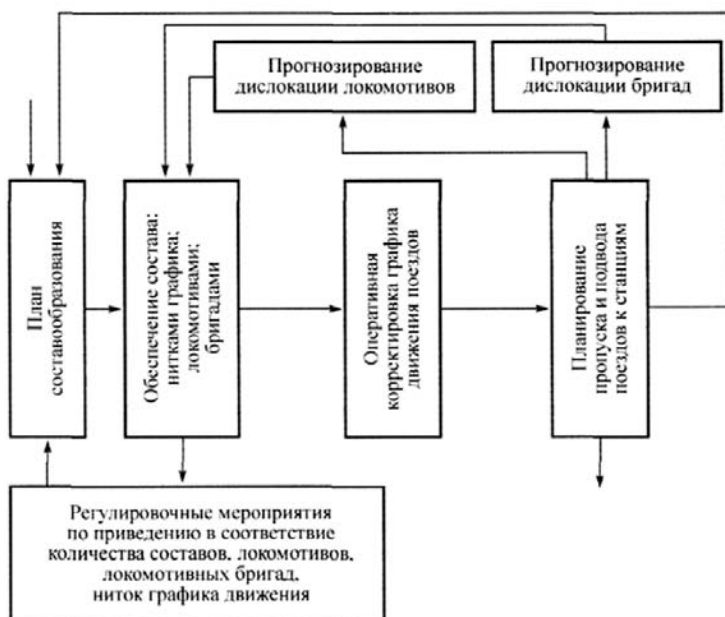
Рис. 1. Блок-схема технологического процесса оперативного управления поездной работой [выполнено автором].
