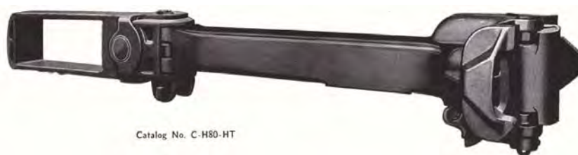
Рис. 5. Автосцепка AAR Standard H в комплектации с тяговым хомутом [16].
