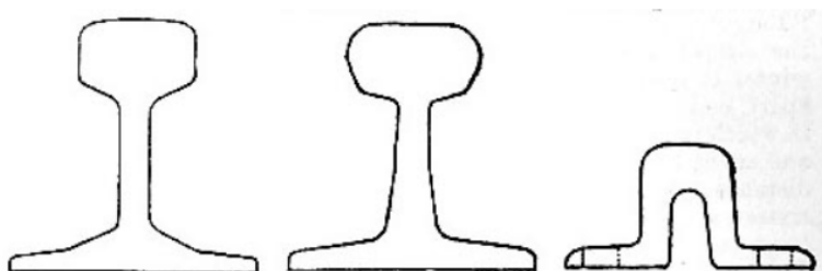
Рис. 6. Широкоподошвенный рельс, применявшийся на железных дорогах, соответственно, Нового Южного Уэльса, Большой Мидлендской железной дороге, Большой Западной железной дороге. [Электронный ресурс]: https://www.1902encyclopedia.com/R/RAI/railway-27.html . Доступ 11.06.2021.
