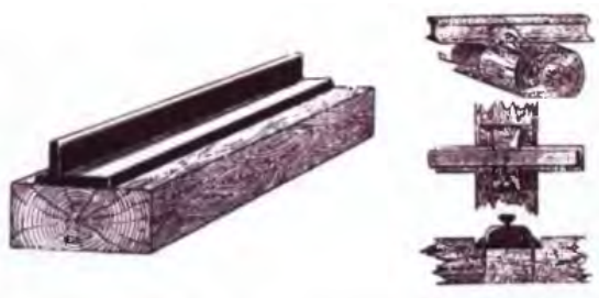
Рис. 2. Изображение деревянного лежня с железной накладкой с закраиной (уголковый рельс). [Электронный ресурс]: http://www.rzd-expo.ru/history/history_of_railway_track/ . Доступ 11.06.2021.
