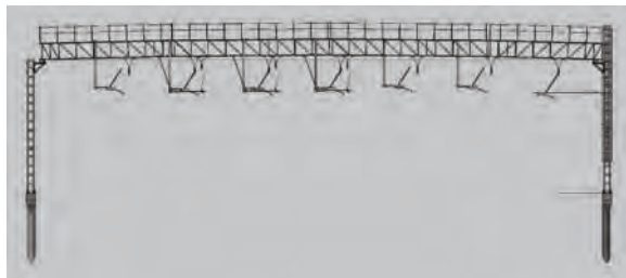
Рис. 5. Пример сборки сложного семейства. Армирование жёсткой поперечины поддерживающими конструкциями с применением автоматизации подбора инструментов визуального программирования [выполнено авторами].
