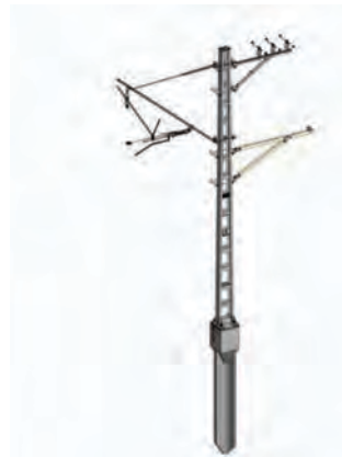
Рис. 3. Пример сборки сложного семейства. Опора контактной сети [выполнено авторами].
