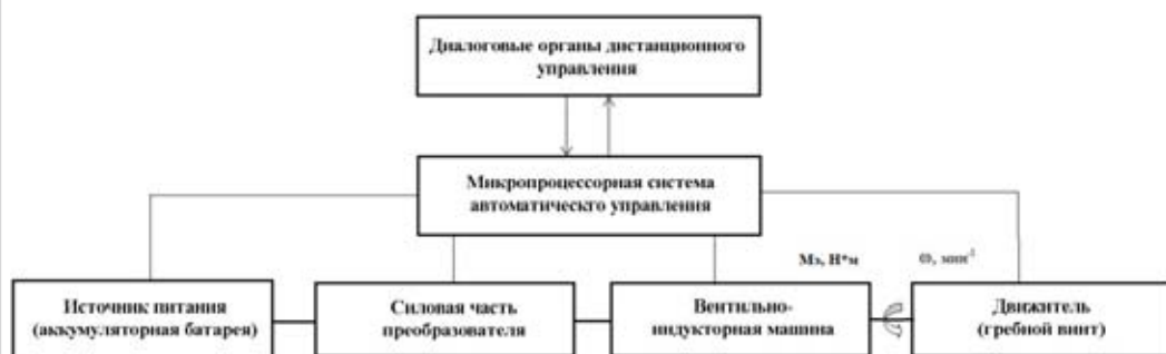
Рис. 1. Блок-схема системы управления движением ОПА [выполнено авторами].
