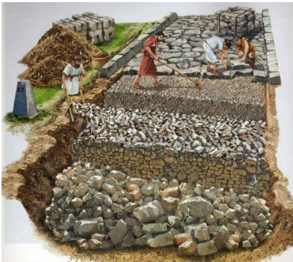
Рис. 5. Художественная иллюстрация технологии строительства римских дорог с послойной детализацией кладки. (Как строились римские дороги. [Электронный ресурс]: https://pikabu.ru/story/kak_stroilis_rimskie_dorogi_5870592 . Доступ 11.06.2021).
