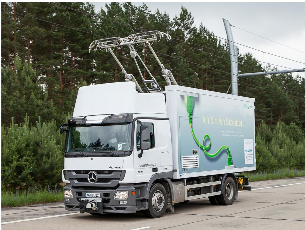
Рис. 5. Система электроснабжения для тяжёлых коммерческих транспортных средств на тестовой линии в окрестностях Берлина (фото «Сименс»: <https://press.assets.siemens.com/content/siemens/press/ui/en/search.html#/asset/sid:320d002d-fa74-4a64-882c-715abfa3b6e5>).
