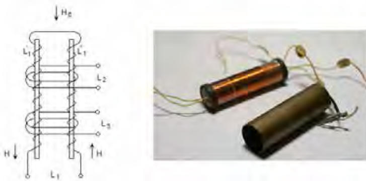
Рис. 1. Устройство феррозонда: H – поле возбуждения феррозонда, H_0 – измеряемое магнитное поле (выполнено авторами).
