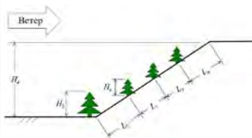
Рис. 5. Схема лесопосадки на подходе к мостовым сооружениям [8].
