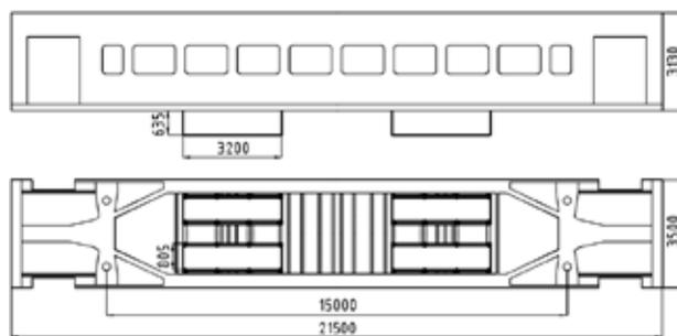
Рис. 1. Конструктивная схема кузова вагона электропоезда (выполнена автором).
