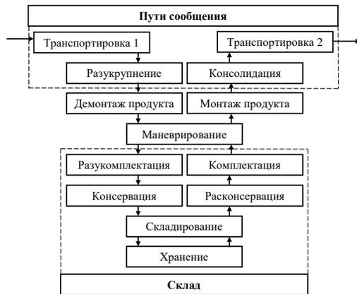
Рис. 2. Последовательность процессов (операций) управления потоками материальных ресурсов (разработано автором).
