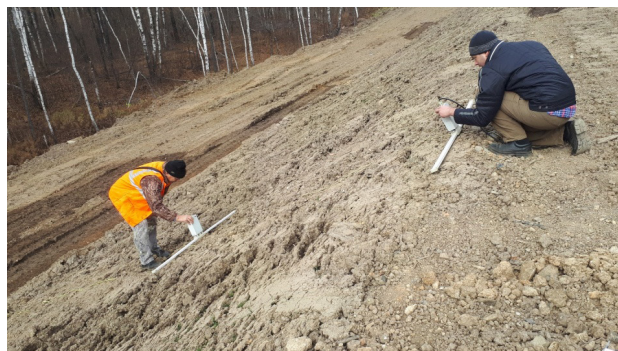
Рис. 8. Проведение георадарного зондирования на переменной базе на откосе бермы (предоставлено авторами).
