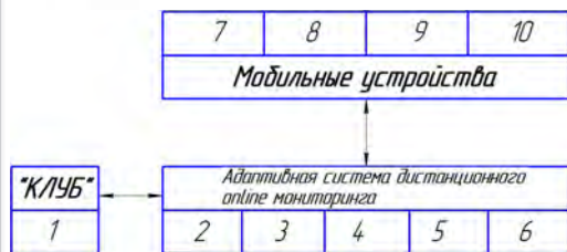
Рис. 1. Схема взаимодействия программной и аппаратной частей рекомендательной системы безопасности в локомотиве: 1 – локомотив, оснащённый системой КЛУБ; 2 – база данных; 3 – центральный сервер; 4 – веб-сайт; 5 – программное Web-приложение; 6 – результаты оценки риска в цветовой гамме; 7 – локомотивная бригада (машинист-инструктор); 8 – инспектор-приёмщик ЦТ ОАО «РЖД»; 9 – заводской инспектор ЦТА ОАО «РЖД»; 10 – ревизоры региональной и центральной структуры ОАО «РЖД».
