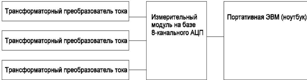
Рис. 3. Структурная схема экспериментальной установки.
