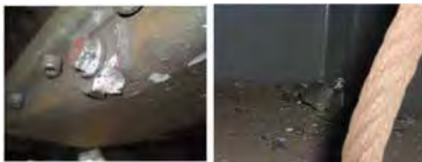
Рис. 1. Повреждения корпуса вагона от ударов частиц щебня [6].
