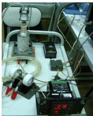
Рис. 4. Терморегулируемая приставка для исследования газообразных продуктов от изоляционного материала с калибровочной кюветой.
