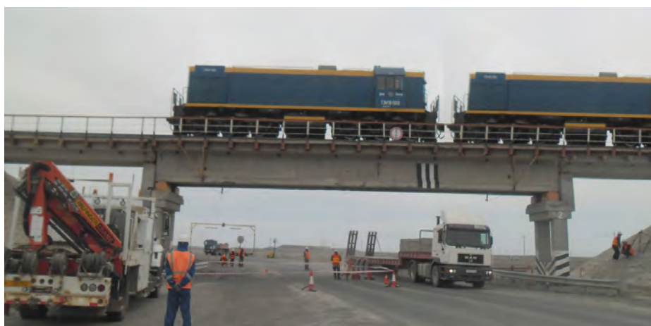
Рис. 5. Фотография установки сплочки «3 локомотива» на пролётное строение 1–2 (нагрузка L4) (сделана авторами).
