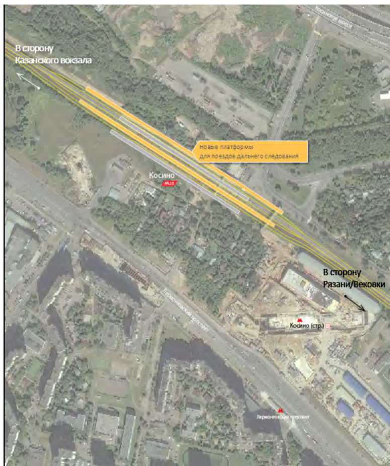
Рис. 5. Предлагаемая конфигурация транспортно-пересадочного узла Косино (рисунок составлен авторами).
