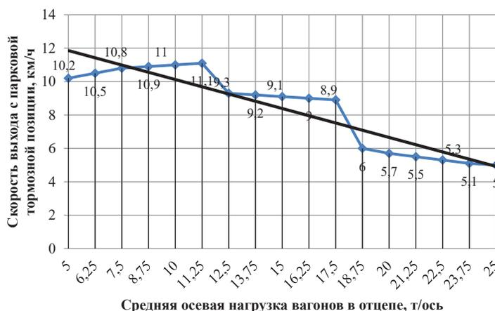
**Рис. 2. Зависимость максимально допустимой скорости выхода отцепа с парковой тормозной позиции от средней осевой нагрузки вагонов в отцепе при скорости ветра  $VB = 0$  м/с.**
