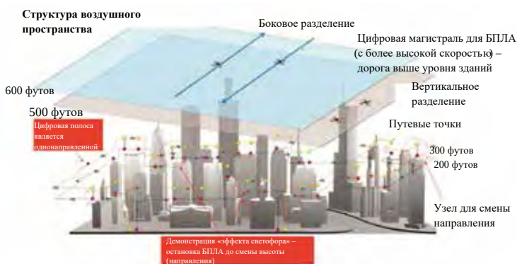
Рис. 3. Иллюстрация структуры управления городским движением БПЛА в воздушном пространстве Сингапура, разрабатываемая NTU [12].
