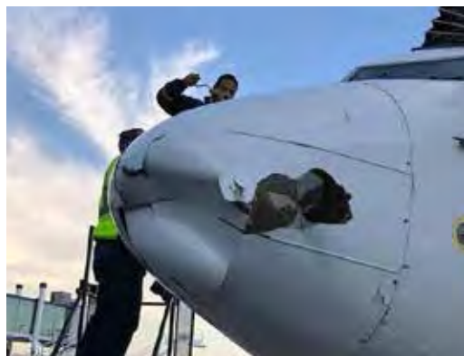
Рис. 5. Авиалайнер, получивший повреждения при столкновении с беспилотником [20].
