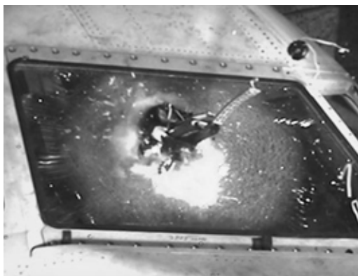
Рис. 4. Беспилотник, пробивающий лобовое стекло кабины авиалайнера в процессе проведения теста [13].
