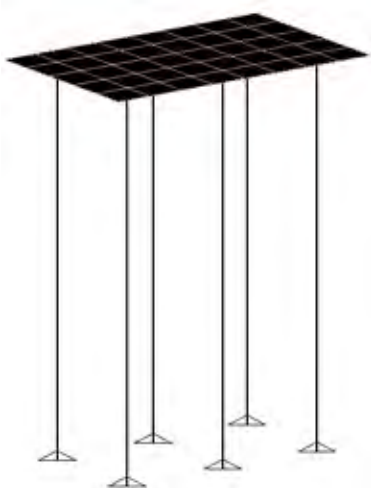
Рис. 5. Пространственная модель столбчатого фундамента.
