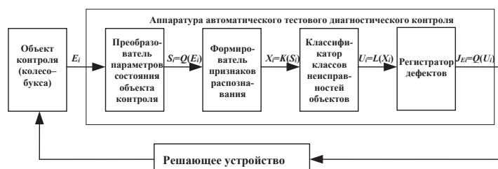
Рис. 2. Структурная схема системы автоматического тестового диагностического контроля буксовых узлов и колёс при движении поезда.
