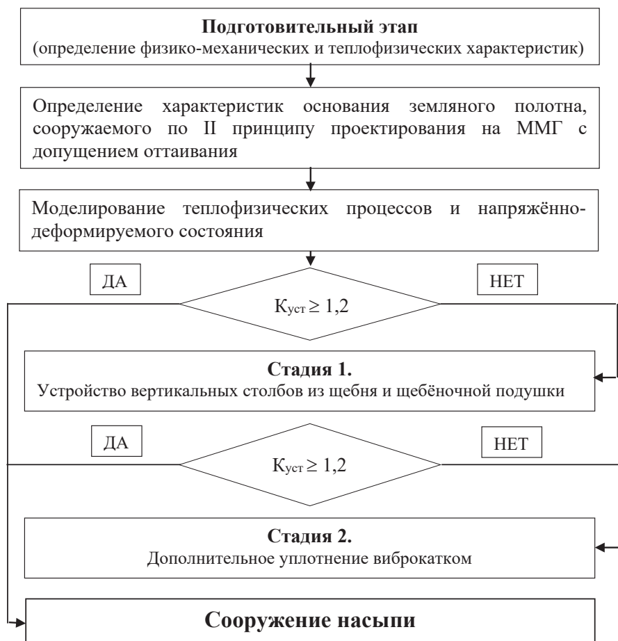
Рис. 1. Принципиальная схема сооружения земляного полотна с допущением оттаивания грунтов на многолетнемёрзлых основаниях с применением армирования вертикальными столбами из щебня: ММГ – многолетнемёрзлые грунты; K_{уст} – коэффициент устойчивости откосов насыпи.
