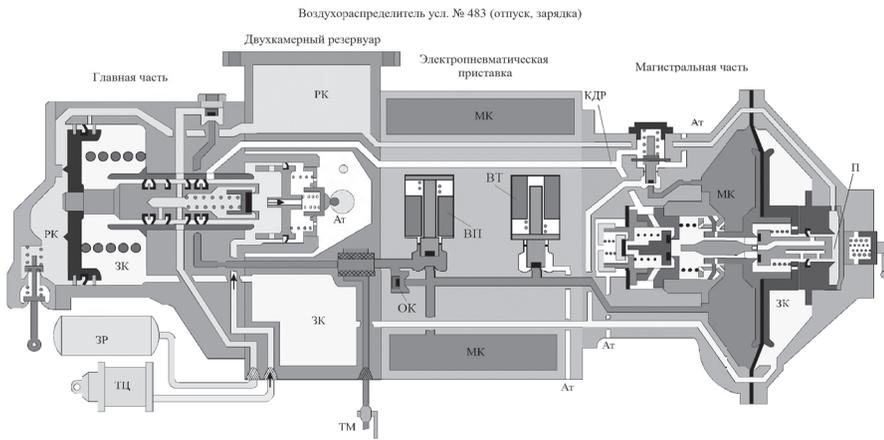
**Рис. 2. Воздухораспределитель, усл. № 483 (отпуск, зарядка).**
