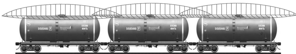
Рис. 2. Схема перекрытия соседних взрывоопасных зон.
