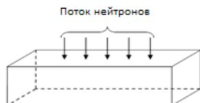
Рис. 3. Схема облучения заготовки из графита.
