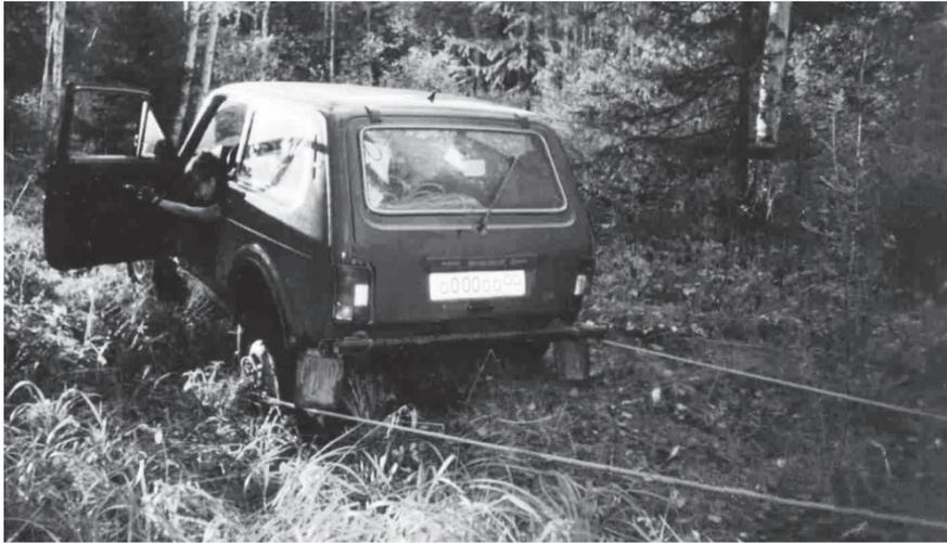
Рис. 3. Барабанный самовытаскиватель в действии.
