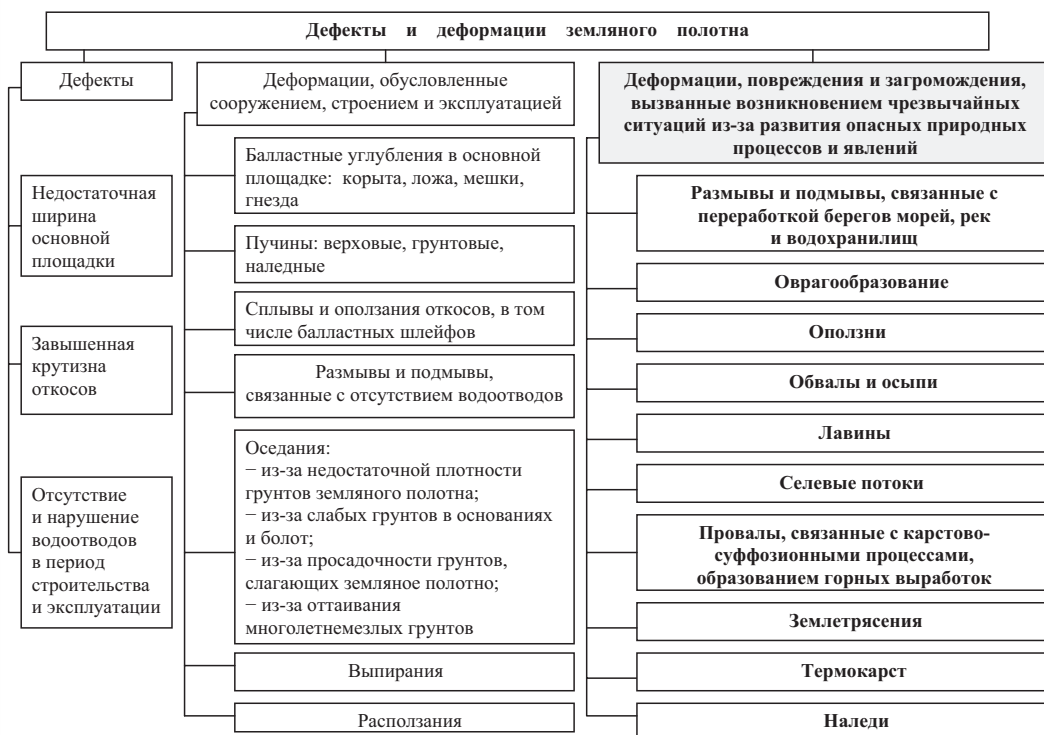
Рис. 2. Классификация дефектов и деформаций земляного полотна.
