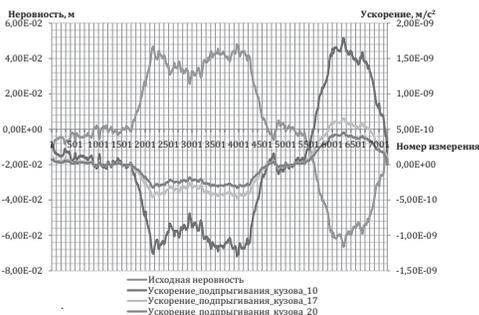
**Рис. 3. Изменения ускорений подпрыгивания подвижного состава в зависимости от скоростей движения.**
