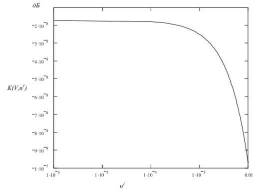
Рис. 5. Зависимость нормированного интеграла перекрытия от флуктуаций  $n^1$ .
