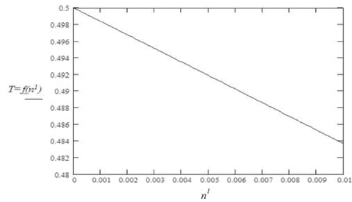
Рис. 4. Зависимость коэффициента передачи от флуктуаций  $n^1$ .
