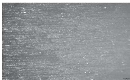
Рис. 6. Поверхность из железографита, обработанная твёрдым сплавом с покрытием TiN (x200).
