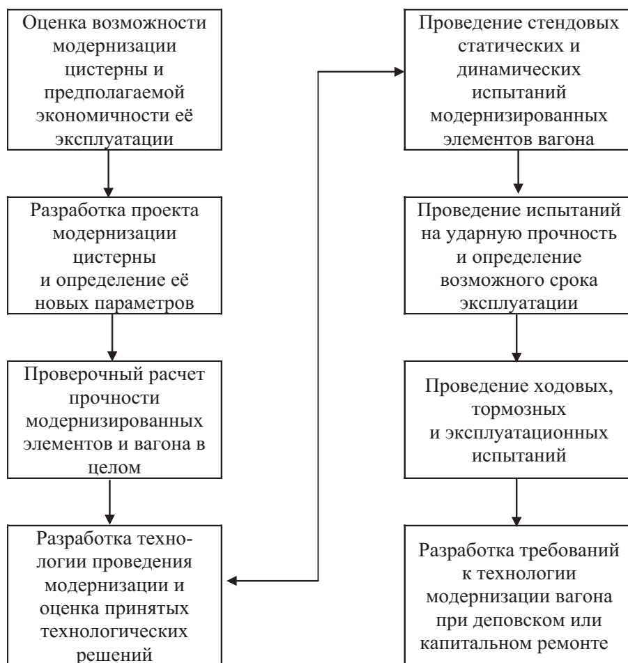
Рис. 1. Блок-схема методики оценки работоспособности модернизированного котла вагона-цистерны.
