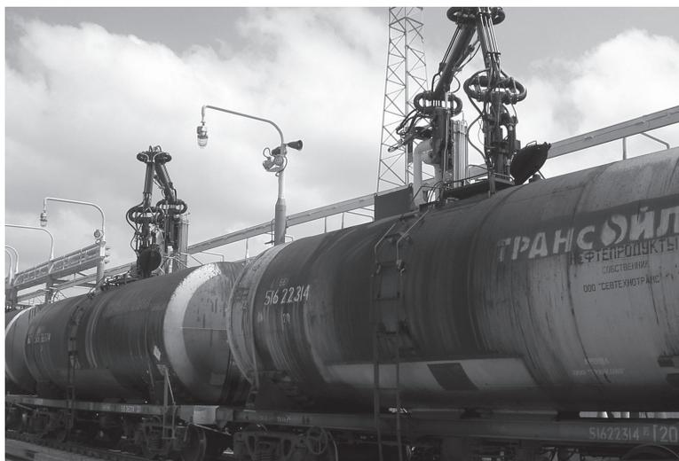
**О**бслуживающему персоналу, работающему на нефтеналивных терминалах в холодных регионах, хорошо известен тот факт, что перевозимая в железнодорожных вагонах сырая нефть может оказаться слишком густой для разгрузки. Финская компания Neste Jacobs разработала разгрузочное устройство Esoarm, способное обеспечить оптимальный процесс при низких температурах воздуха.
