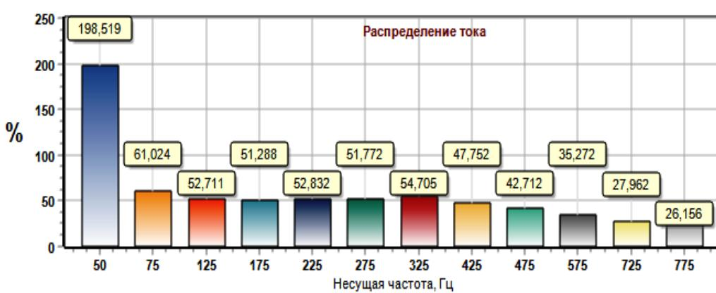
Рис. 7. Столбчатая диаграмма максимальных величин действующих значений гармоник тягового тока ЭПС на несущих частотах в процентном соотношении к нормируемым уровням по результатам моделирования.
