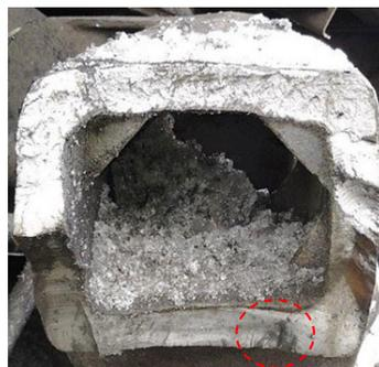
Рис. 2. Сечение излома боковой рамы тележки производства Amsted Rail.
