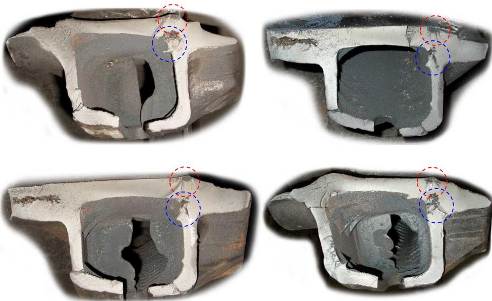
**Рис. 6. Внутренние дефекты в изломах боковых рам из одной изготовленной партии.**
