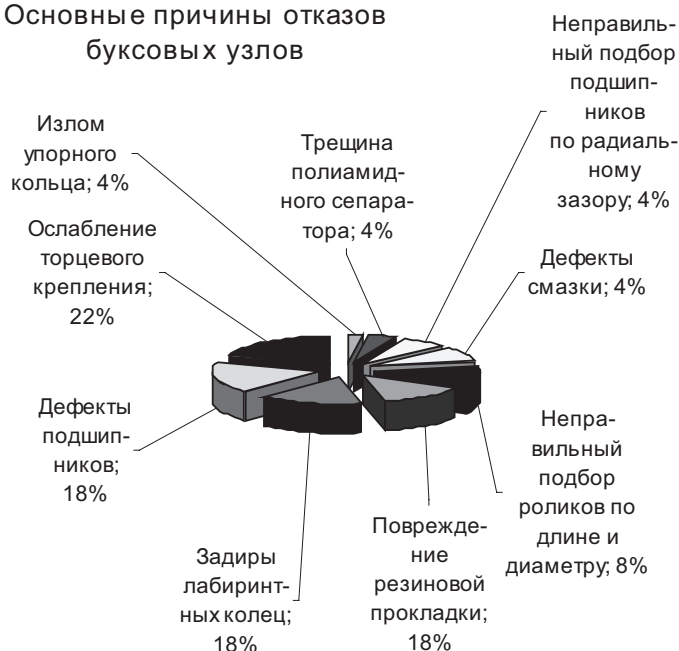
Рис. 2. Распределение неисправностей буксовых узлов по причинам.
