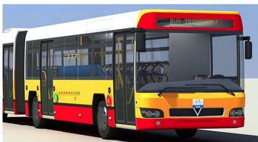
Рис. 2. Автобус МАЗ-107, модернизированный в автовелобус.
