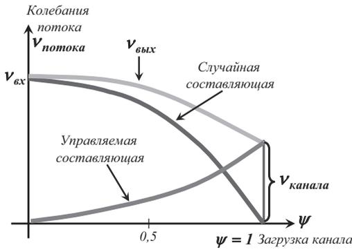
Рис. 7. Изменение характера потока после выхода из бункера.
