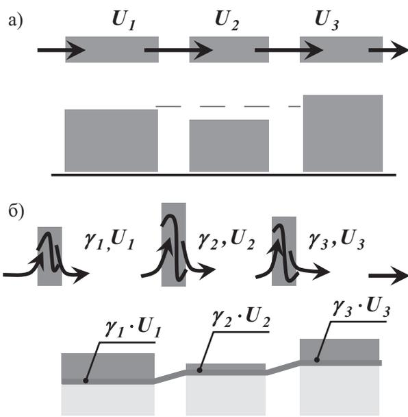
Рис. 9. Определение ограничивающего функционального элемента.
