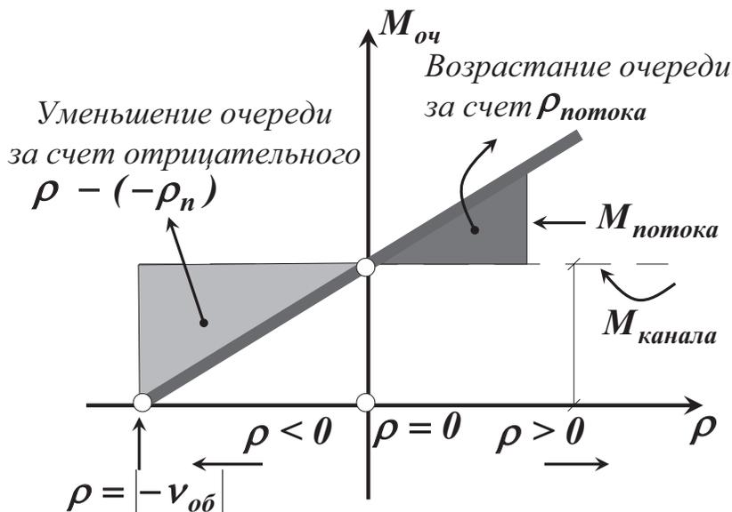
Рис. 4. Преобразование потока бункером.
