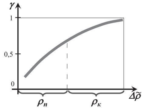
Рис. 8. Повышение коэффициента возможной полезной загрузки канала при увеличении ёмкости бункера.
