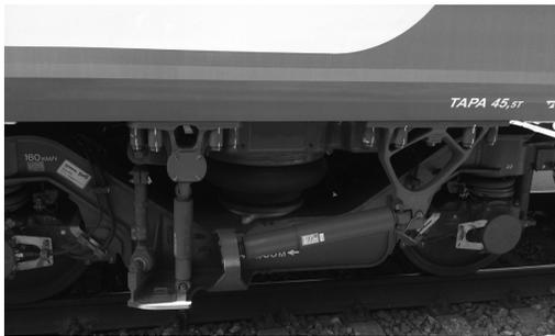
**Рис. 6. Пневматическое подвешивание на электропоезде «Desiro RUS».**
