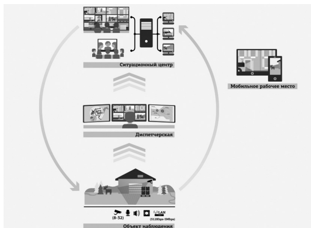
Структурная схема системы дистанционного видеомониторинга
