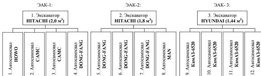
Рис. 2. Состав ЭАК, принятый в расчетах.
