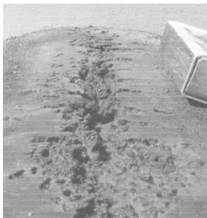
**Рис. 5.** Кавитационная эрозия стенки цилиндра дизельного двигателя тепловоза, в системе охлаждения которого использовали воду с трехкомпонентной нитрито-фосфатной присадкой, не защищающей от кавитации.
