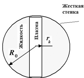
Рис. 1. Геометрическая модель сферической полости с цилиндрическим разрядным каналом.
