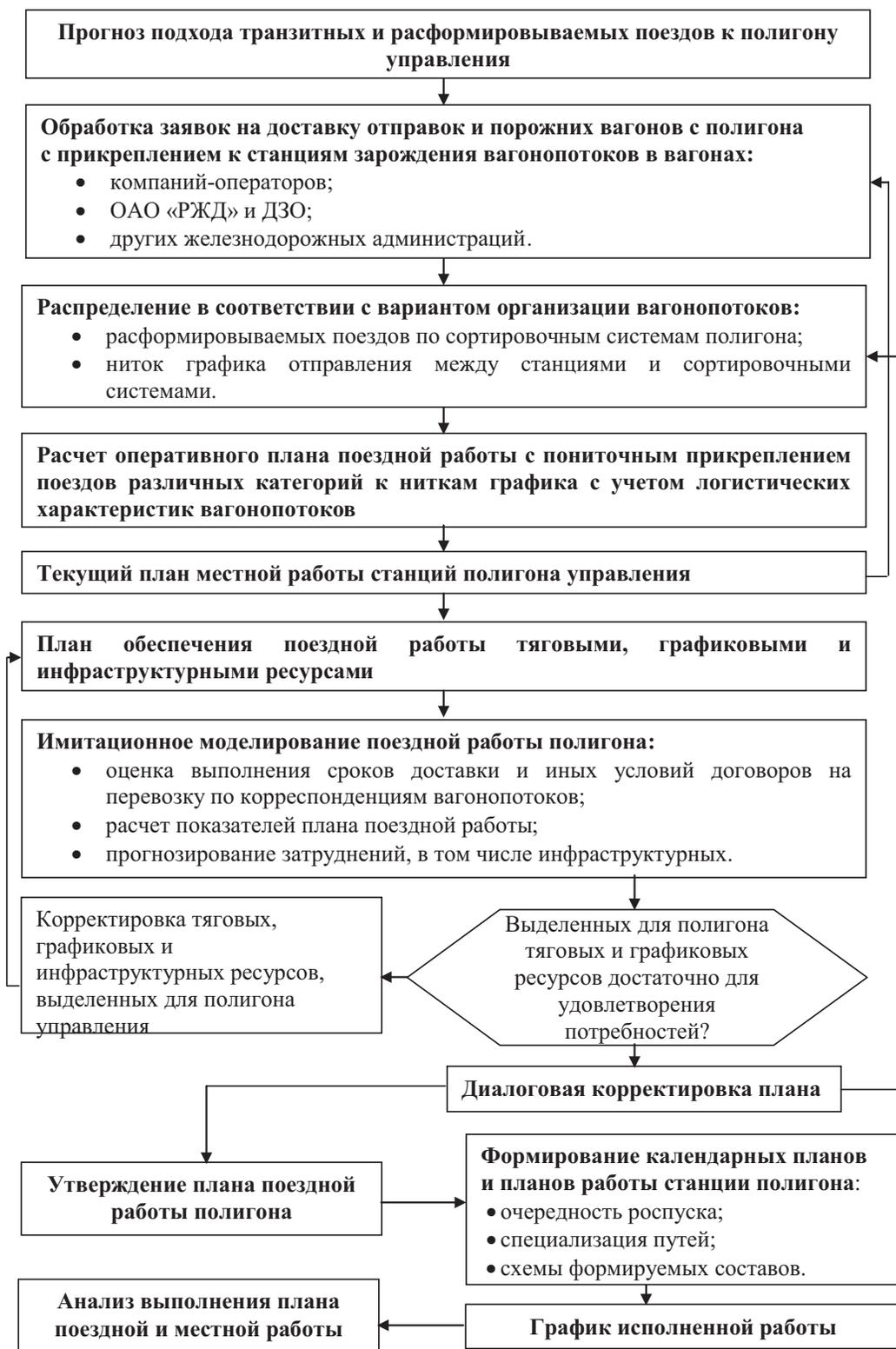
Рис. 2. Укрупненная схема оперативного планирования поездной работы.
