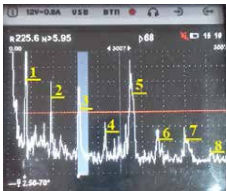
Рис. 6. Дефектограмма выявления отражателей в НО ПЭП П121–2,5–70-РДМ:
