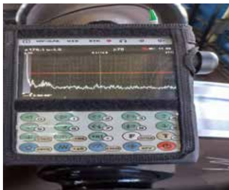
Рис. 5. Дефектограммы годного колеса колесной пары после обточки на колесотокарном станке, полученные ПЭП 2,5Р65°69°74° а – до установки ПЭП; б – после установки ПЭП на поверхность катания [фото авторов].
