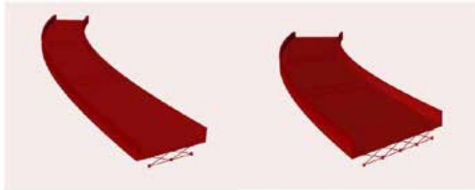
Рис. 4. Количество балок определяет изменение проезжей части моста [выполнено автором].
