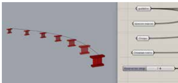
Рис. 2. Простой скрипт Grasshopper для бетонных опор моста [выполнено автором].
