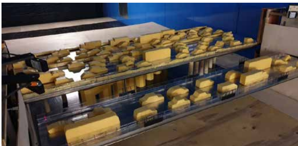
Рис. 8. Схема проведения эксперимента по оценке количества и расположения экипажей на пролетном строении на его аэродинамическую устойчивость [выполнено О. И. Поддаевой, П. С. Чуриным, А. Н. Федосовой].
