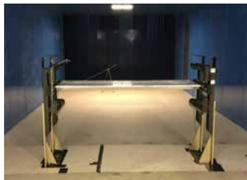
Рис. 4. Установка для испытания макета мостового перехода в аэродинамической трубе [выполнено О. И. Поддаевой, П. С. Чуриным, А. Н. Федосовой].
